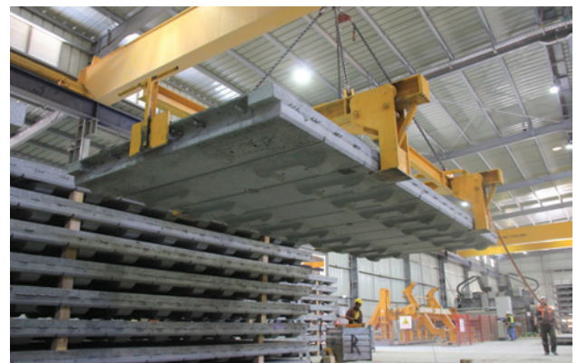
ייצור מיסעות הבטון במפעל טרומי בשער הגיא. תמונה באדיבות אלקטרה
